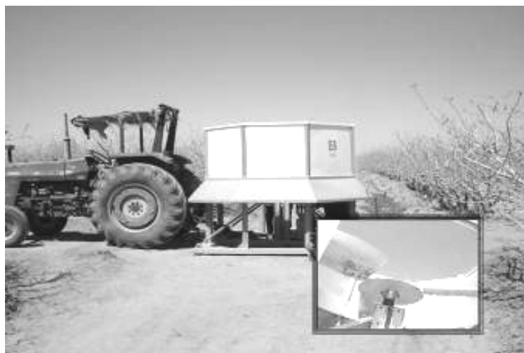
شکل ۱- چاهک معکوس با استفاده از نیروی P.T.O تراکتور
