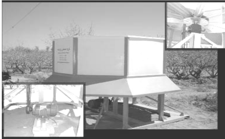
شکل ۲- چاهک معکوس با استفاده از نیروی الکترو موتور
