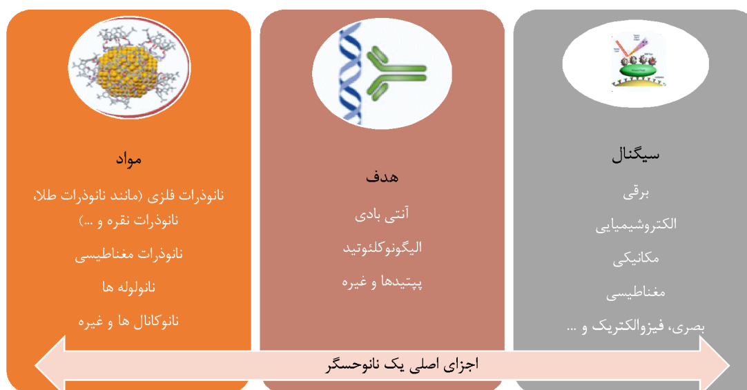
تصویر ۱. اجزای اصلی یک نانوحسگر (Kashyap et al. , 2019)
